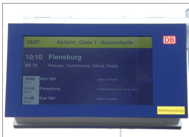
Abbildung 19: Eine Mischung aus Zugzielanzeiger und Abfahrtsmonitor wurde auf den Bahnsteigen in Eckernförde zum Test installiert. Die offizielle Bezeichnung ist „ZugInfo-Monitor“ (ZIM).
